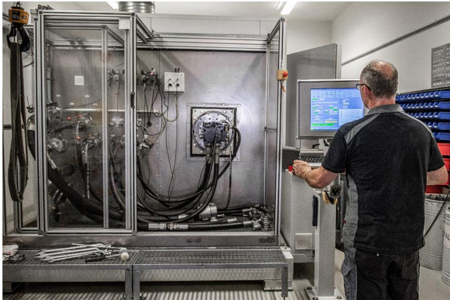
*Hydraulikprüfstand von Jetschke Hydraulik*
